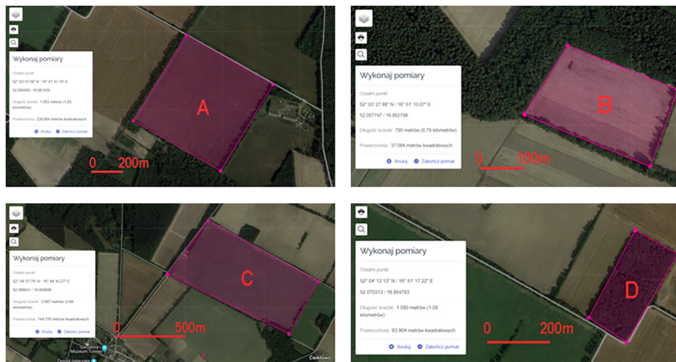
Ryc. 4. Przykładowe pomiary fotometryczne pasów, wnętrz oraz innych form zadrzewień – numeracja rysunku A, B, C, D odnosi się do ryc. 3B Źródło: opracowanie własne.
